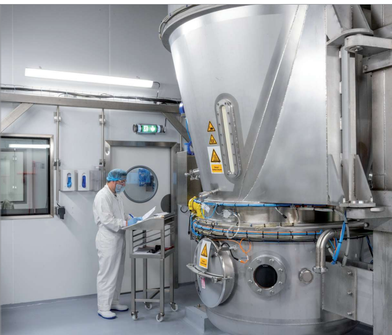
Das Sprühtrocknungsverfahren verwandelt flüssige Stoffe in Pulver und wird oft zur Herstellung von Backwaren, Nahrungsergänzungsmitteln oder anderen Produkten eingesetzt.
